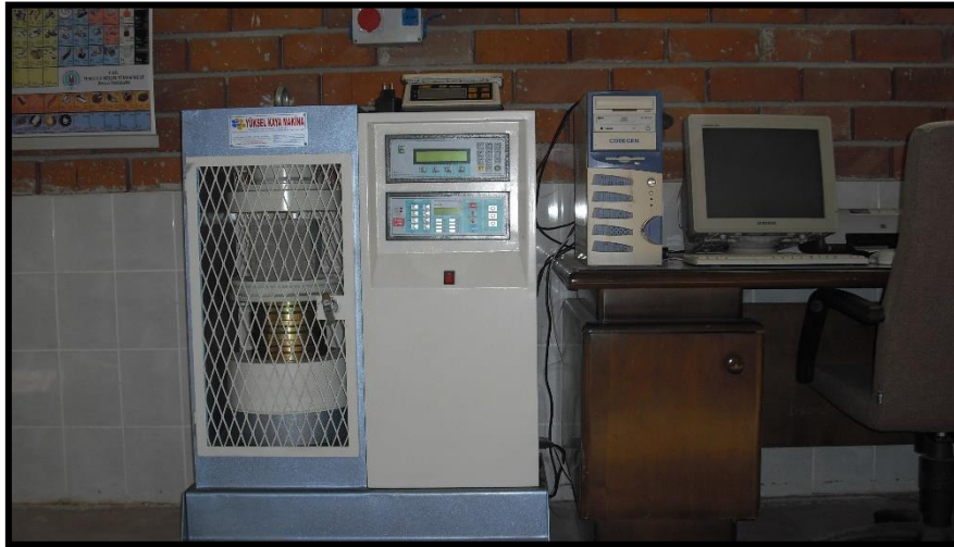
Tam Otomatik Beton Test Presi ( 200 ton kapasiteli )
